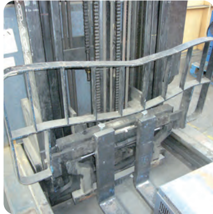
► Schutzgitter stark verformt
